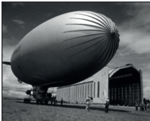
Imagem 34: Fotografia de dirigível não rígido tipo blimp, modelo K-84, atracado ao lado do Hangar do Zeppelin, já Base Aérea de Santa Cruz, no bairro de Santa Cruz, Rio de Janeiro. Este modelo de mais-leve-que-o-ar foi empregado pela Marinha dos Estados Unidos da América do Norte na patrulha antissubmarina ao longo da costa brasileira entre 1942-1945. Fonte da imagem: http://www.uboatarchive.net/U-134A/U-134AirshipPhotos.htm . Acesso em: 28 mar. 2015.
